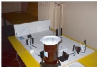
• Mediante un calcolatore tecnico (real-time) è stato possibile correlare le due scelte A e B che consentono di leggere in modo diretto i valori di "n" e di " $\lambda$ " per diversi colori. Sostituendo due di questi valori è possibile ottenere, con la formula sopra esposta al punto 6, una stima quantitativa della "dispersività" del vetro: comparando il presente, una grandezza fisica inedita che caratterizza i materiali trasparenti.
