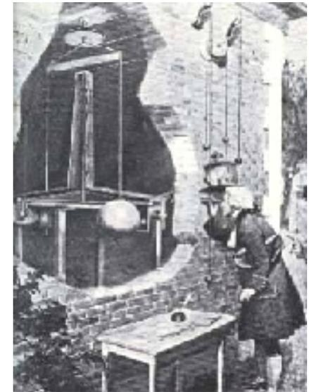
**Nel 1798 Henry Cavendish (1731-1810) realizzò un grande apparato sperimentale per determinare la densità media della Terra. Cioè per pesare la Terra. Ovvero, in termini moderni per determinare il valore di  $G$  cost di gravitazione universale.**
