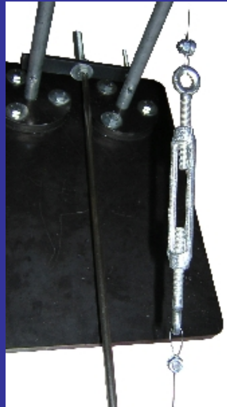
La base d'appoggio e parti della struttura di sostegno dell'asta oscillante.
